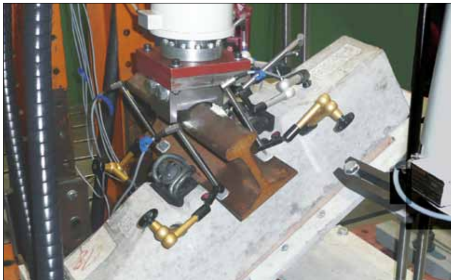
Dauerschwingversuch an einer Schienenbefestigung (Foto: TU Dresden, Professur für Gestaltung von Bahnanlagen, Prof. Fengler)
