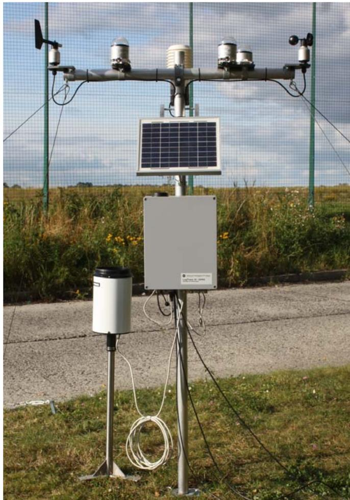
Die UIT GmbH Dresden bietet automatische Wetterstationen an. Das Herzstück dieser Wetterstationen ist der bewährte Datenlogger LogTrans 16. Die eingesetzten meteorologischen Sensoren werden von renommierten Anbietern beigestellt. Folgende Messgrößen werden typischerweise für eine automatische Wetterstation eingesetzt.
