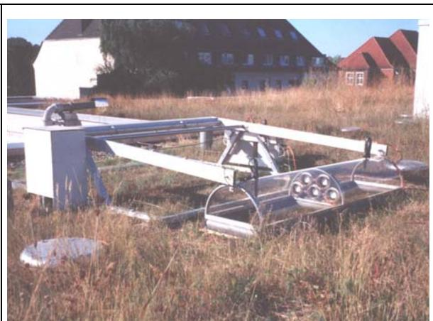
Abb. 2: Tunnel-Verdunstungsmessgerät, dargestellt im abgesenkten Zustand
